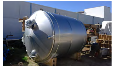
TANQUE CAMISA FRIO Y AGITADOR 8.500 L (6.500,00)
