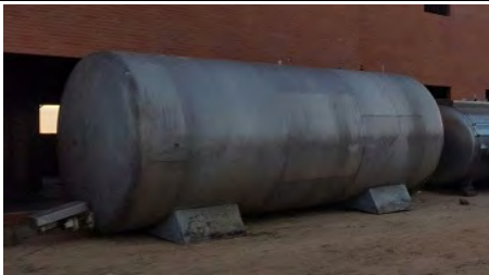
DEPOSITO 15.000 L ACERO INOX + AGITADOR
